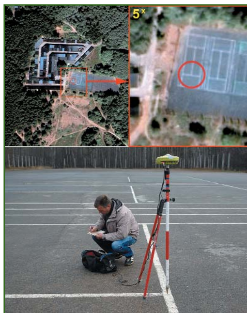
Рис. 1 Пример выбора опознака на снимке — разметка теннисного корта
